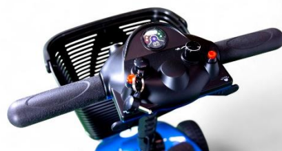
CUADRO DE MANDO Regulador velocidad Luces LED – Claxon Indicador carga batería
