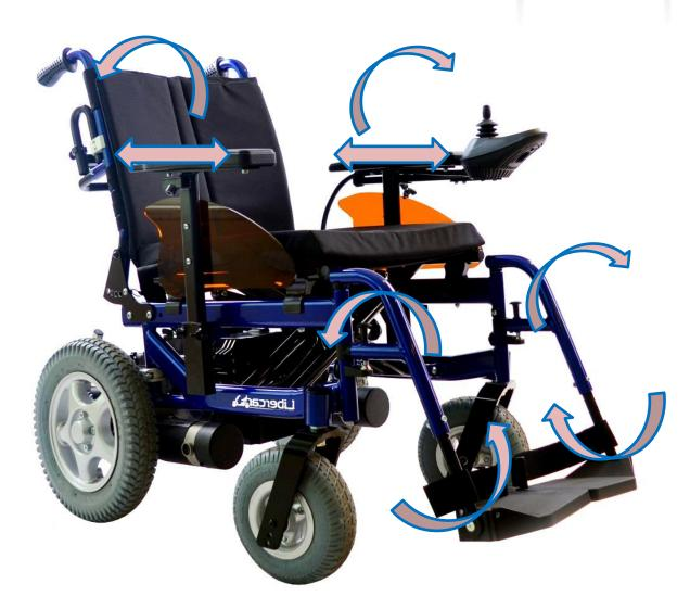
Habitáculo regulable en anchura entre 43cm y 57cm Reposabrazos ajustables en altura (14 cm) y en profundidad (2 pos). Reposapiés plegables hacia arriba y abatibles hacia adentro. Reposapiés regulables en altura y ángulo.
