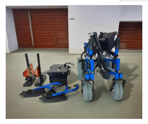
Baterías desmontables para un fácil transporte Reposapiés y reposabrazos extraíbles Peso total silla: 68kg
